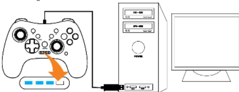
Povežite kontroler sa računarem pomoću Tip-C kabla. Nakon što ga Windows sistem prepozna, kontroler će početi da radi, LED 1,2,3 lampica će dugo svetleti.
