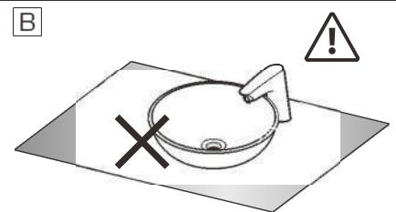
Preporučuje se izbegavanje postavljanja uređaja za sušenje u blizini objekata sa visokom refleksijom (ogledalo, umivaonici od nerđajućeg čelika, itd.) kako bi se izbegla neispravna funkcija senzora prisutnosti.
