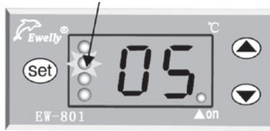
**Električni grejač se uključuje** kada je zbir zadate temperature (**T<sub>z</sub>**) i podešene vrednosti ( $\Delta T_{gpu}$ ) manji ili jednak temperaturi vode u bojleru (**T<sub>b</sub>**).
