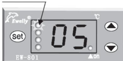
**Uređaj uključuje cirkulacionu pumpu** kada je zbir temperature u bojleru (**T<sub>b</sub>**) i podešene vrednosti ( $\Delta T_{pu}$ ) jednak ili veći od temperature solarnog kolektora (**T<sub>s</sub>**).
