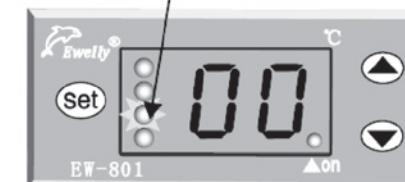
Opseg korekcije temperature:  $-10^\circ C \sim 10^\circ C$ , fabrički podešeno: 0
