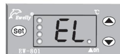
Kada je senzor bojlera u kratkom spoju ili nije povezan na displeju će pojaviti „EL“.
