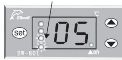
**Električni grejač se isključuje** kada je zbir zadate temperature (**T<sub>z</sub>**) i podešene vrednosti ( $\Delta T_{pgi}$ ) veći ili jednak sa temperaturom solarnog panela (**T<sub>s</sub>**).
