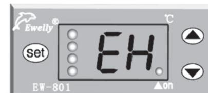
Kada je senzor solarnog kolektora u kratkom spoju ili nije povezan na displeju će pojaviti „EH“.
