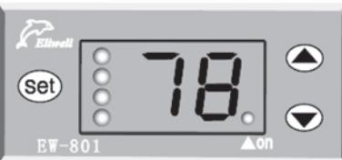
Za prikaz temperature solarnog kolektora (**T<sub>s</sub>**) pritistnite i pridržite taster .
